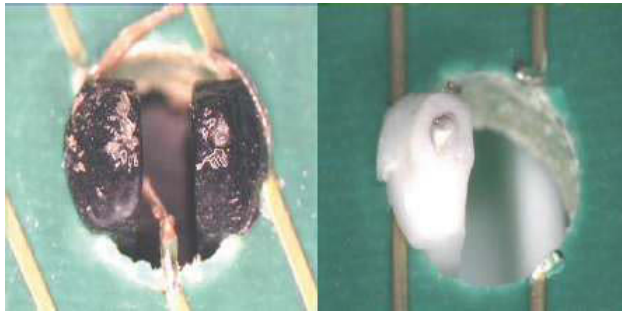
Bild 4.1 Verbrannte Einpresszapfen und Zinnkügelchen bei Nylongehäusen nach dem Wellenlöten
